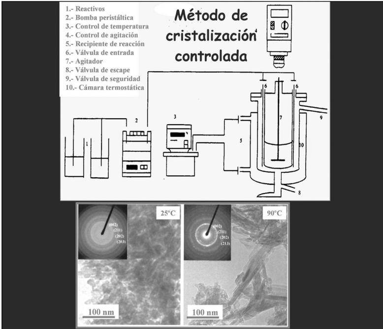
**Fig. 4. Esquema del método de cristalización controlada. Micrografías TEM y DE de los nanocristales de apatita obtenidos.**
